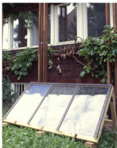
Abbildung 17: Testelement mit drei rückseitig vakuumgedämmten Solarabsorbern.
