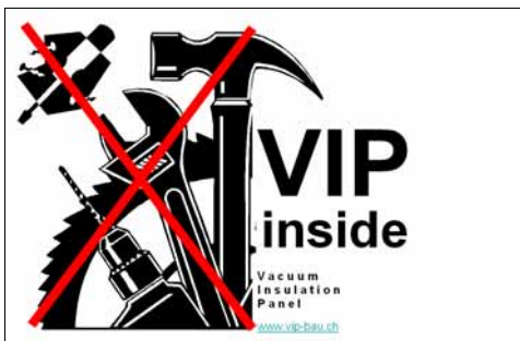
Abbildung 56: Entwurfsskizze einer selbstklebenden Warnbeschriftung zur Kennzeichnung von VIP-Panel und Bauteilen mit VIP.
