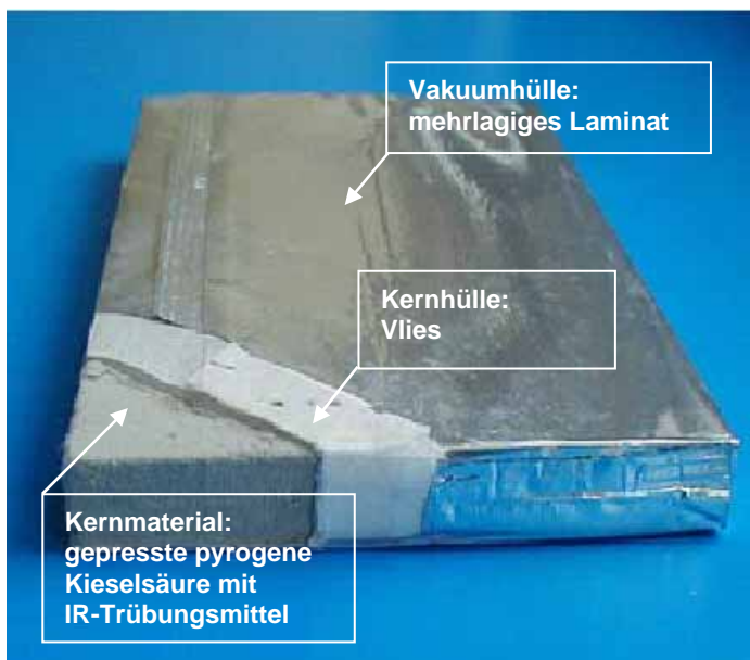
Abbildung 1: Vakuums-Isolations-Paneele (VIP) bestehen aus einem nanoporösen Kern, welcher im Vakuum in ein gasdichtes Hüllmaterial eingeschweisst wird. (Quelle: va-Q-tec)
