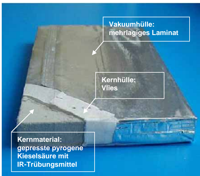
Abbildung 5: Komponenten eines VIP. Das Vlies gewährleistet im Herstellungsprozess die mechanische Stabilität des Kernmaterials und schützt die Produktionsumgebung während des Vakuumier- und Einschweißvorgangs vor Verunreinigung durch Kieselsäurepulver. (Quelle: va-Q-tec)
