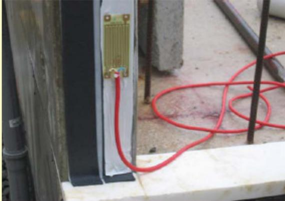
**Einbau von Sensoren im VIP-Stoßfugenbereich**
