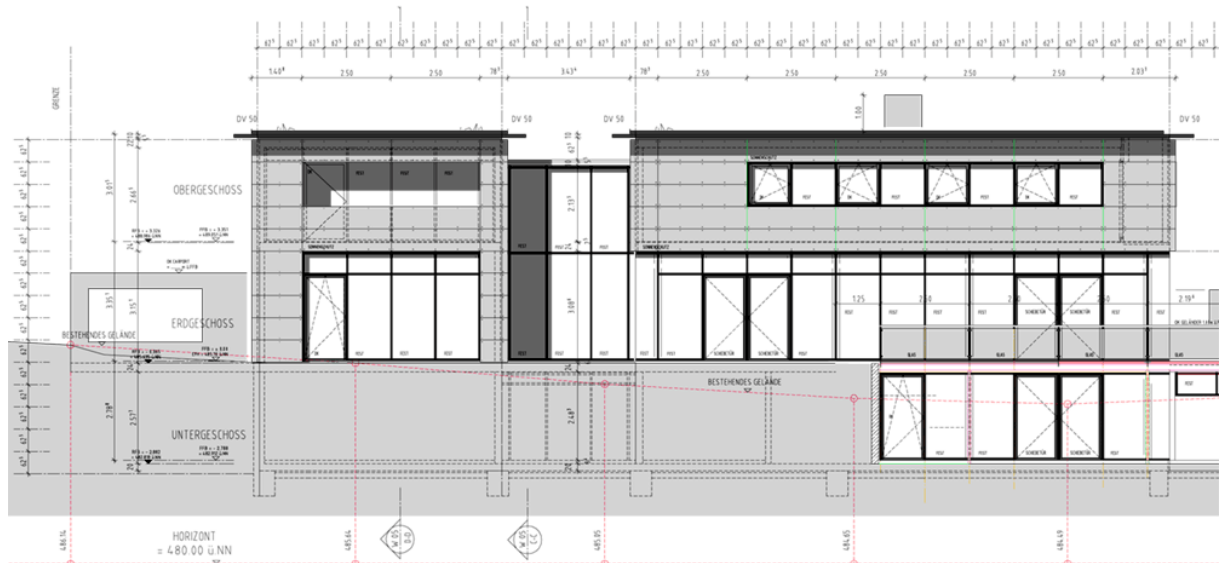
Bild 2: Westansicht Demogebäude mit horizontaler und vertikaler Rasterung
