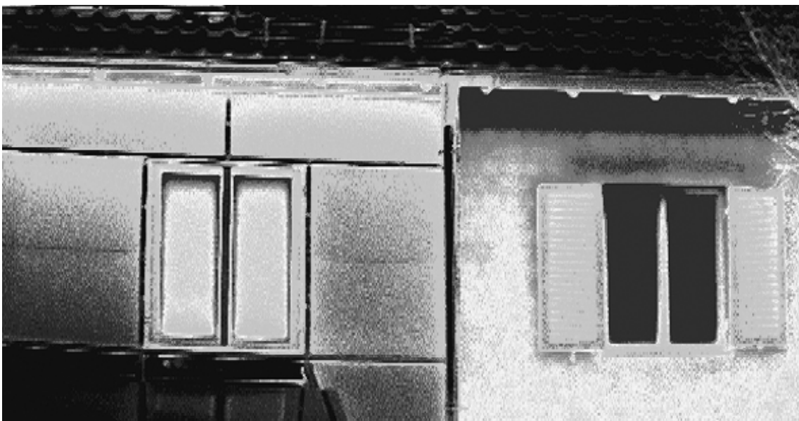
Bild 12: Thermografie mit Nachbarhaus, März 2002, t_i links = 23^\circ\text{C} , t_i rechts 17^\circ\text{C} , t_a = -4^\circ\text{C}
