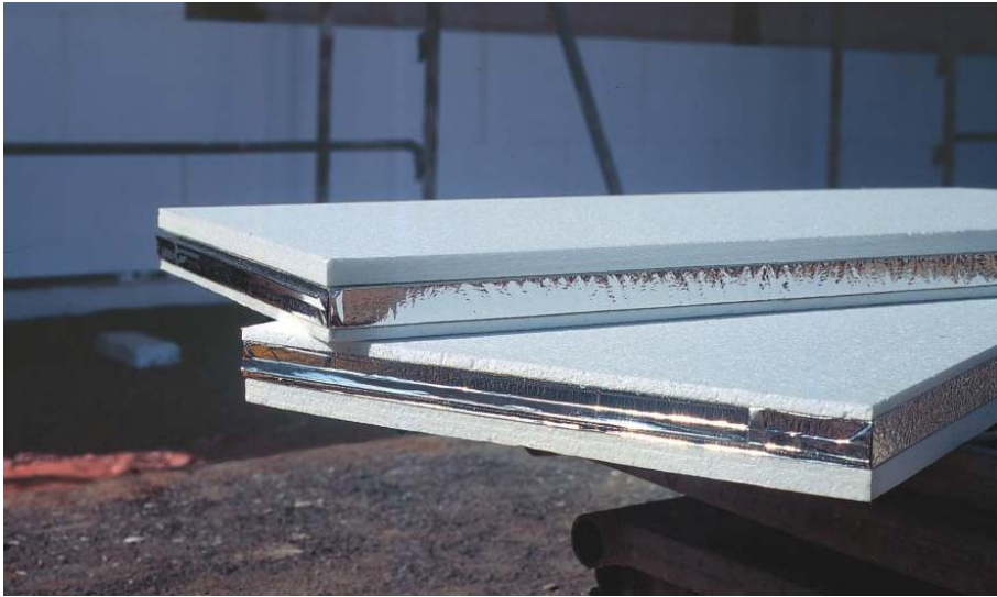
Abb.: 10) beidseitig EPS kaschierte VIP's
