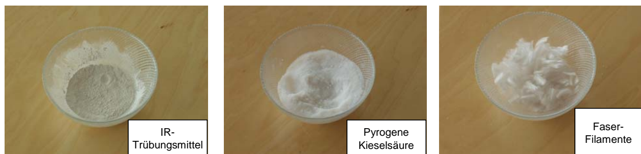
Bild 1: Komponenten einer Standardmischung für Wärmedämmplatten
