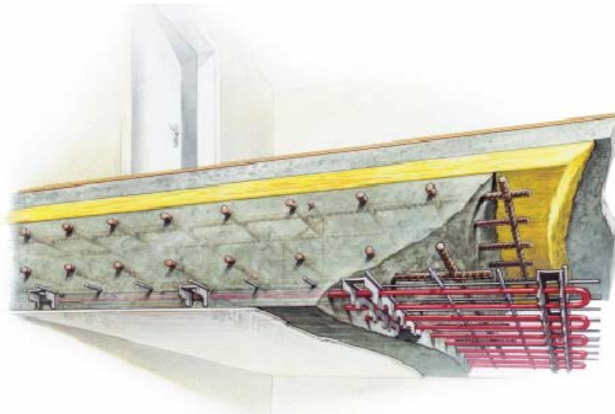
Abbildung 4: Schematische Darstellung eines Deckenheiz- und Kühlsystems (Hybridsystem) in einer Massivdecke. (Bild: RCS, System Climacool RBO-90)
