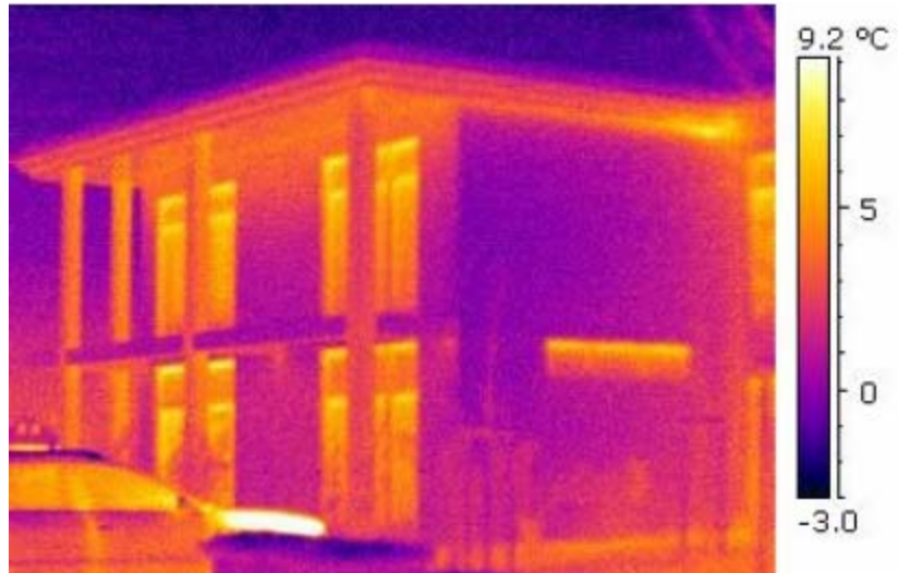
Abb.: 8) Thermografie des Passivhauses Bersenbrück
