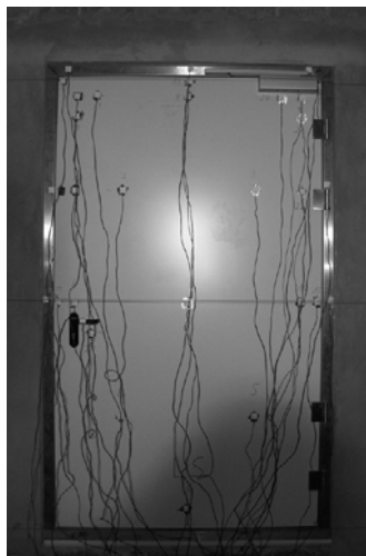
Bild 11: Die T90 – Brandschutztüre eingebaut in die Prüfkammer
