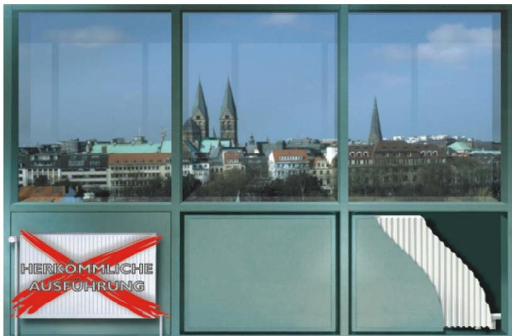
Das KLIMAPANEEL® der Firma BOETKER ist ein patentrechtlich geschütztes Brüstungselement mit integriertem Heiz- und Kühlsystem und entspricht den heutigen Ansprüchen von Ästhetik, Technik und Klimaschutzverordnungen. In genialer Manier wird dieses Element wie eine herkömmliche Fassadenfüllung, mit z.B. 26 mm Einspannstärke, in eine Pfosten-Riegel oder Fensterkonstruktion eingesetzt.
